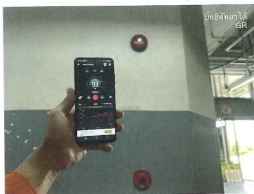
รูปที่ 2.68 ทดสอบ Alarm Bell พื้นที่บริเวณหน้าห้อง GR และ วัดค่าเสียงได้ที่ 93
