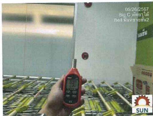
รูปที่ 2.71 ทดสอบ Alarm Bell พื้นที่บริเวณห้างสรรพสินค้า และ วัดค่าเสียงได้ที่ 93
