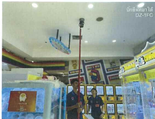
รูปที่ 2.52 ทดสอบ Heat Detector พื้นที่บริเวณห้างสรรพสินค้า
