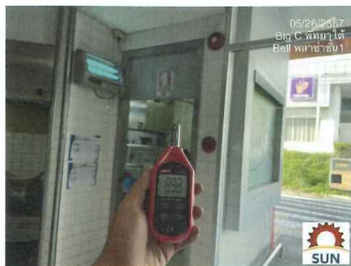
รูปที่ 2.76 ทดสอบ Alarm Bell พื้นที่บริเวณห้องครัวแคนทีน และ วัดค่าเสียงได้ที่ 89.8
