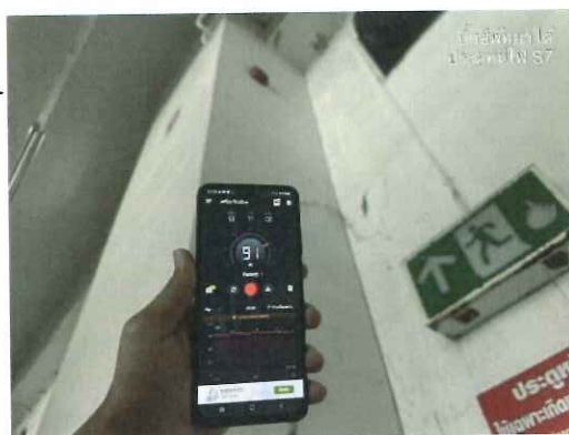
รูปที่ 2.69 ทดสอบ Alarm Bell พื้นที่บริเวณประตูหนีไฟ S7 และ วัดค่าเสียงได้ที่ 91
