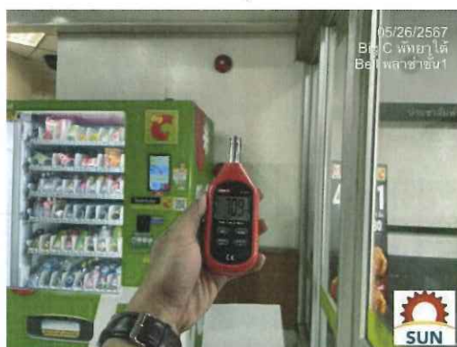
รูปที่ 2.78 ทดสอบ Alarm Bell พื้นที่บริเวณประตูประชาสัมพันธ์ และ วัดค่าเสียงได้ที่ 70.9
